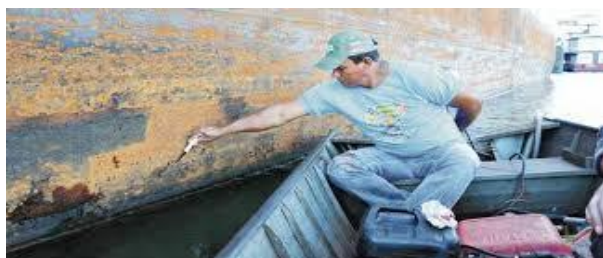
Figura 13: Retirada de incrustações em cascos de embarcações
